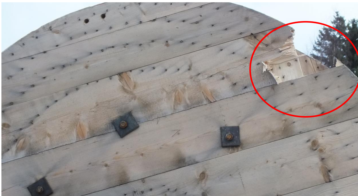
KUVA 1, LM = LAIPPA ON MURTUNUT
